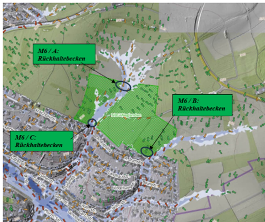
Abbildung 19: Maßnahmen Außengebietszuflüsse NBG Weglanden
